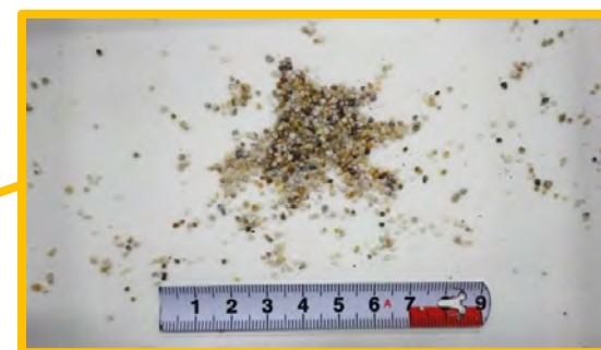
砂（三河桂砂V3号，平均粒径：1.3mm）
