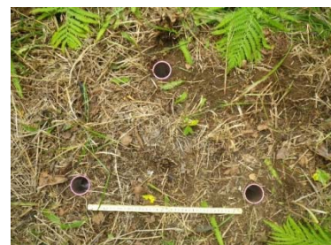
土砂トラップ設置状況
